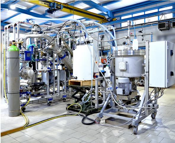
Pilotanlage mit Rotationscheibenmodul
